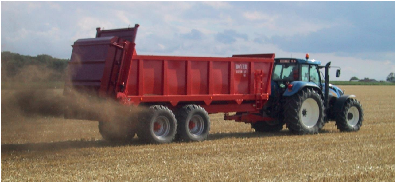
Photographie d'un épandeur à table d'épandage Source : www.remorques-royer.com
